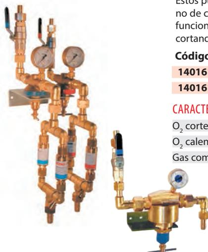
Estos puestos de trabajo triple se basan en el regulador S200 para oxígeno de corte. El gas combustible y el oxígeno de calentamiento se suministran mediante reguladores S200, ambos con los anti retroceso de llama de tres funciones FR91 montados en paralelo para el abastecimiento de grandes maquinas de oxicorte (20 sopletes FIT+ cortando a la vez 100 mm (4") o 6 sopletes FIT+ cortando a la vez 300mm (12").
